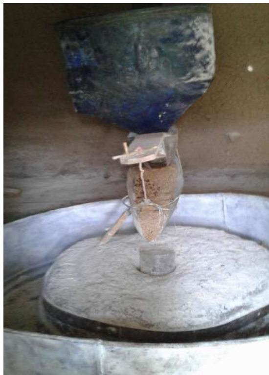
Foto 10. Molino con guardapolvo circular en Epizana 2
