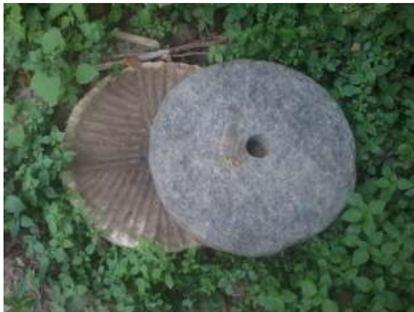
Foto 8. Muelas e desuso mostrando sus estrías en Saucepiapata
